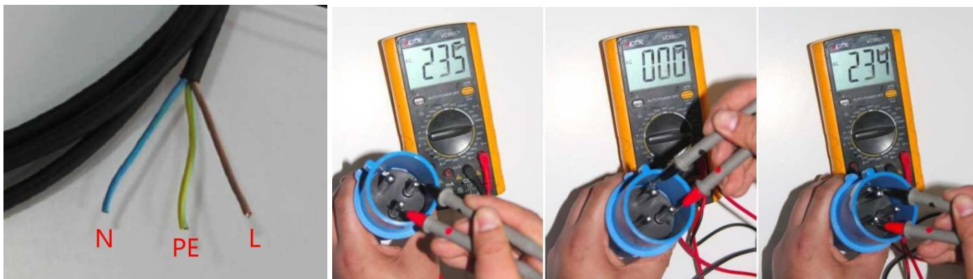
L-N: AC220V~250V N-PE: 0V L-PE: AC220V~250V M-
